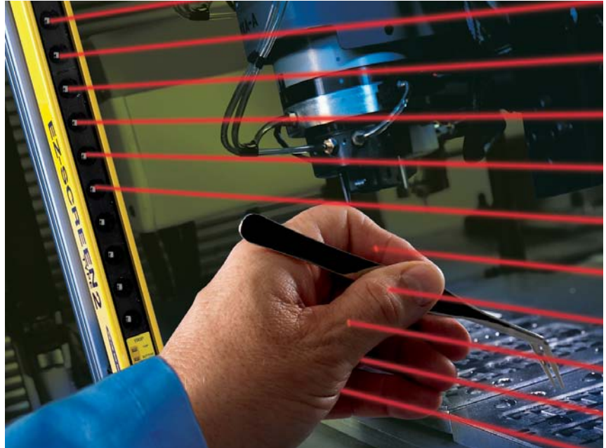
EZ-SCREEN LS2 – Lichtvorhang löst Start und Stop der Maschine aus
