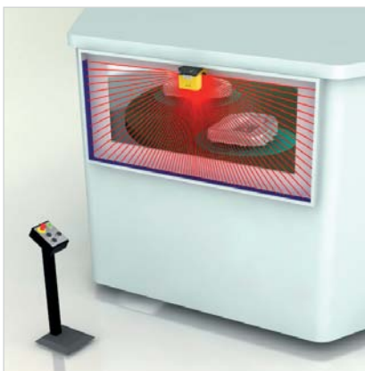
Laserscanner AG4 – Schutz zum Rundtakttisch
